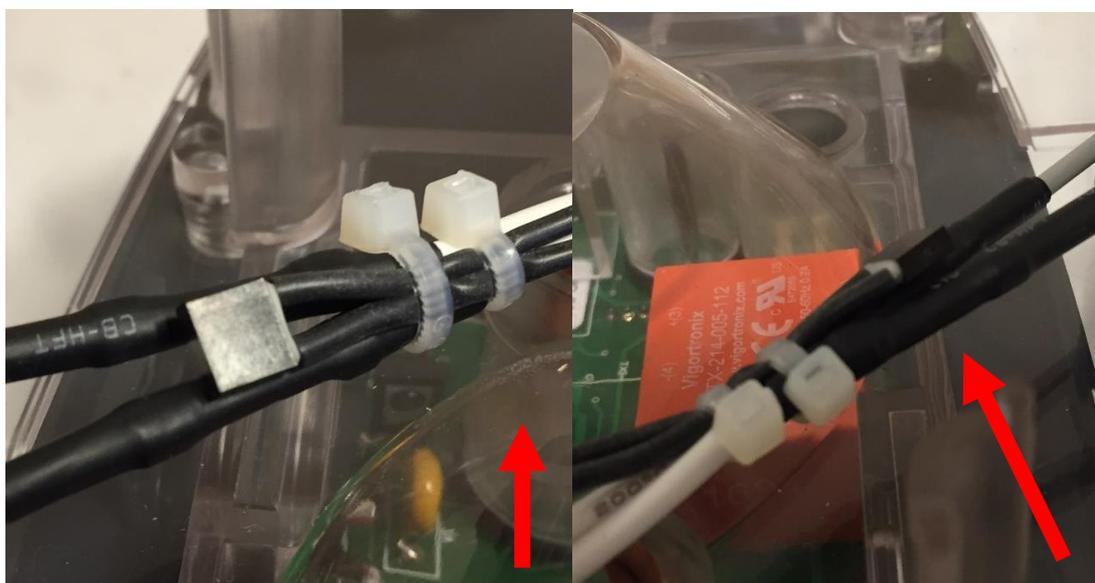
12. Убедитесь, что разъемы вентилятора и устройства поворота яиц соединены правильно и провода полностью утоплены в соединениях. Удерживайте вентилятор в указанном положении, чтобы вставить провода в разъемы. Обратите внимание на провода мотора устройства поворота яиц. Соединители могут быть полностью вставлены на место с помощью маленькой отвертки.
