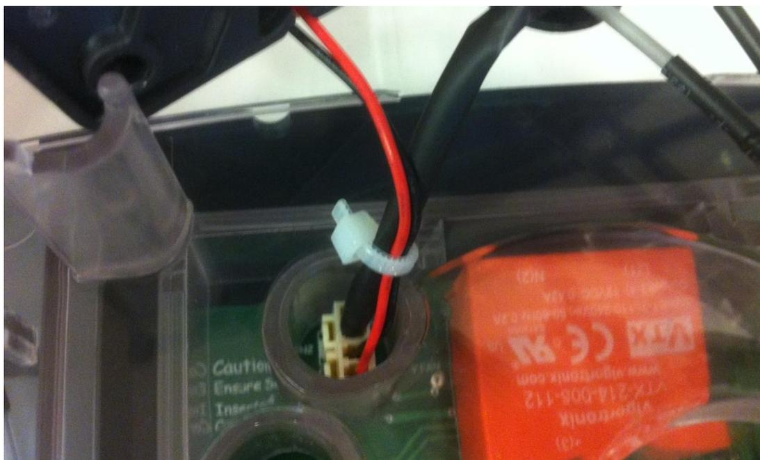
13. Убедитесь, что вентилятор равно расположен на 4 стойках, а мотор устройства поворота яиц расположен в гнезде в верхней части инкубатора. Проверьте, что разъемы вентилятора и мотора остались вставлены в разъемы после установки вентилятора и мотора!
