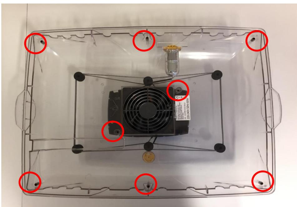
5. Протрите внутреннюю крышку тряпкой, смоченной раствором для дезинфекции инкубатора. После очистки вытрите дезинфицирующее средство влажной тканью смоченной чистой водой.
