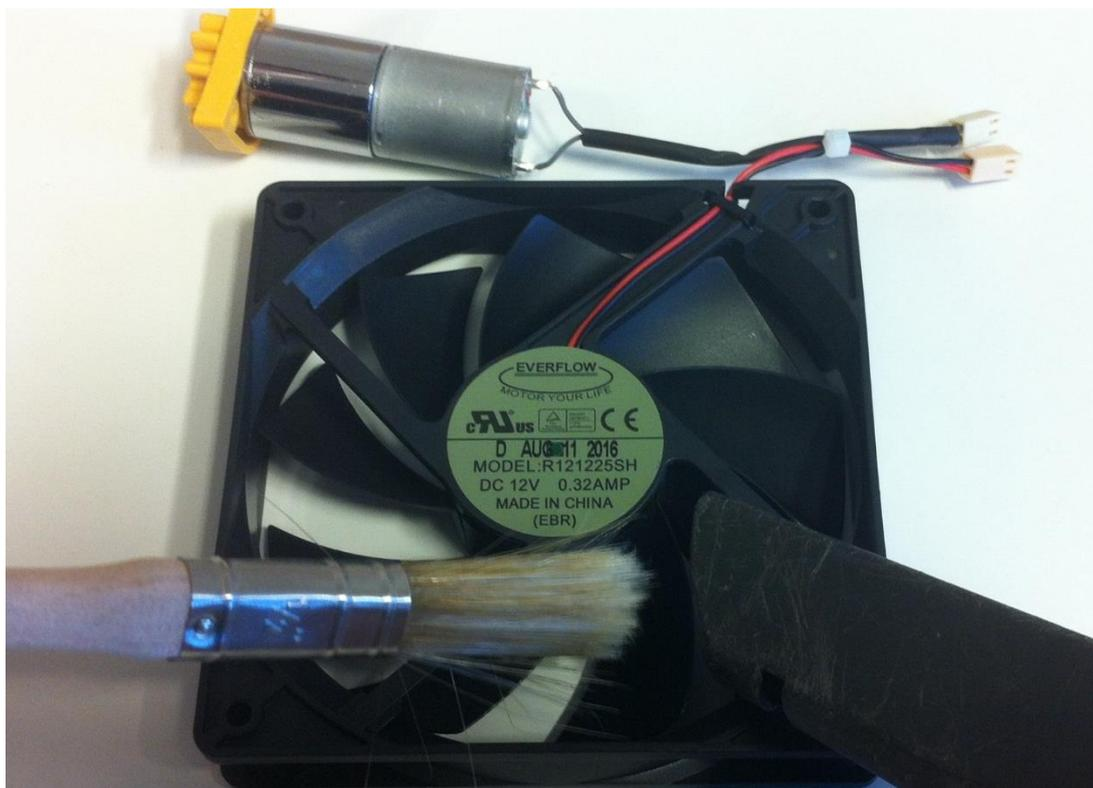
8. Мотор устройства поворота яйца можно очистить тряпкой, смоченной разбавленным раствором дезинфицирующего средства для инкубатора. После очистки вытрите дезинфицирующее средство влажной тканью, смоченной в чистой воде. Не допускайте попадания влаги в двигатель.
