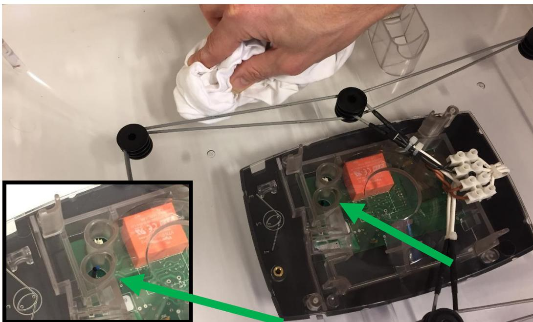
11. После завершения чистки убедитесь, что тепловой предохранитель все еще расположен непосредственно над нагревательным элементом, но не касается его.
